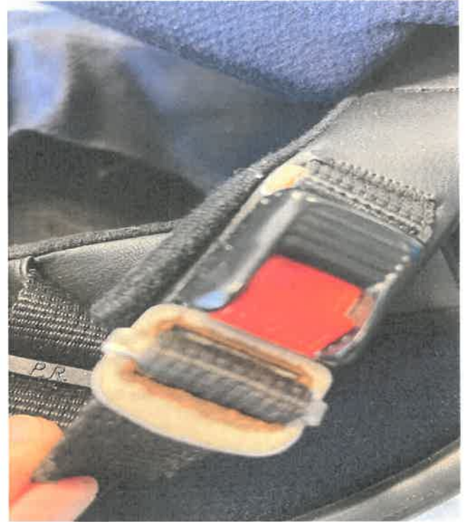
Fotografia detall del sistema d'ancatge amb òxid
