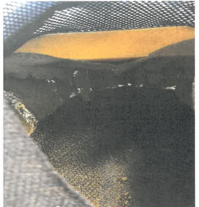
Fotografia de l'escuma EPP degradada
